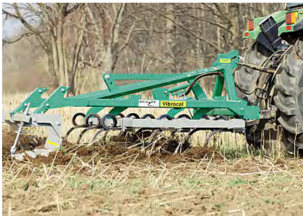
Interessante Tiefenverstellung mit Parallelogrammaufhängung und Hydraulikzylinder.
