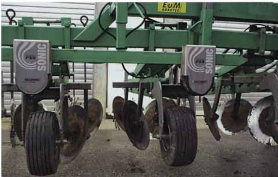
Jedem Vorläufer vorgeschaltet sind die Ultraschallsensoren der Fa. Reichhardt. Sie geben ihre Werte an das Steuerelement weiter, das dann die Maschine hydraulisch ausrichtet.
