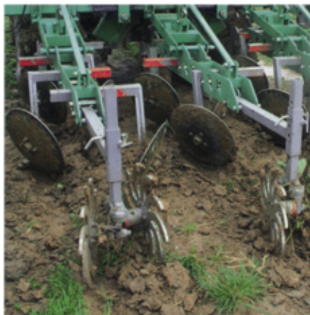
Ein spezieller Winkel der Hohl-scheiben und die Prismennachläufer gewährleisten, dass Beikraut und Ausläufer gleichermaßen Bodenkontakt verlieren und abtrocknen.
